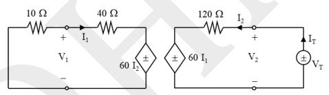
$$\begin{split} &V_2 = V_T \; ; \; I_2 = I_T \\ &50 \; I_1 + 60 \; I_2 = 0 \\ &60 \; I_2 = -50 \; I_1 \\ &I_1 = -1.2 \; I_2 \\ &V_T = 120 \; I_2 + 60 \; I_1 \\ &= 120 \; I_2 - 72 \; I_2 \\ &= 48 \; I_2 = 48 \; I_T \\ &Z_{TH} = \frac{V_T}{I_T} = 48 \; \Omega \end{split}$$
